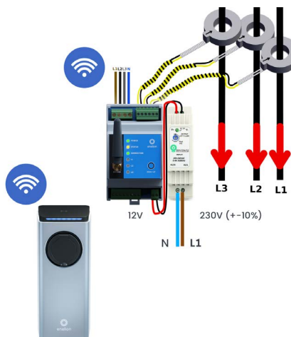
Abb. 5: Anschlusschema für die 3-Phasen-Variante von ENELION ENERGY BEWACHEN.
