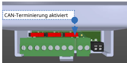
Abb. 15: CAN-Verbindungsabschluss Aktiviert (Schalter in der rechten Position)
